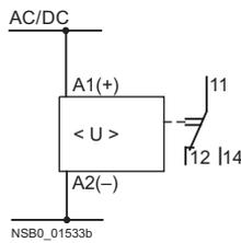
*Hinweis: Eine Absicherung des Messkreises zum Geräteschutz ist nicht notwendig. Die Absicherung für den Leitungsschutz hängt vom verwendeten Querschnitt ab.*
