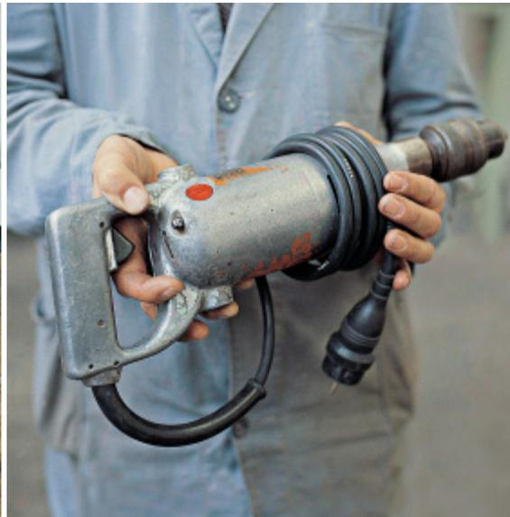
Vor der Benutzung eines elektrischen Betriebsmittels ist das Datum der Wiederholungsprüfung zu kontrollieren
