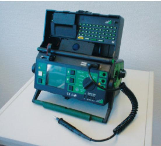
Prüfgerät zur Wiederholungsprüfung elektrischer Geräte
